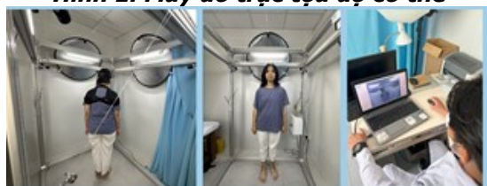
Hình 2. Quy trình đo và kết nối máy tính của máy đo trực toạ độ cơ thể
