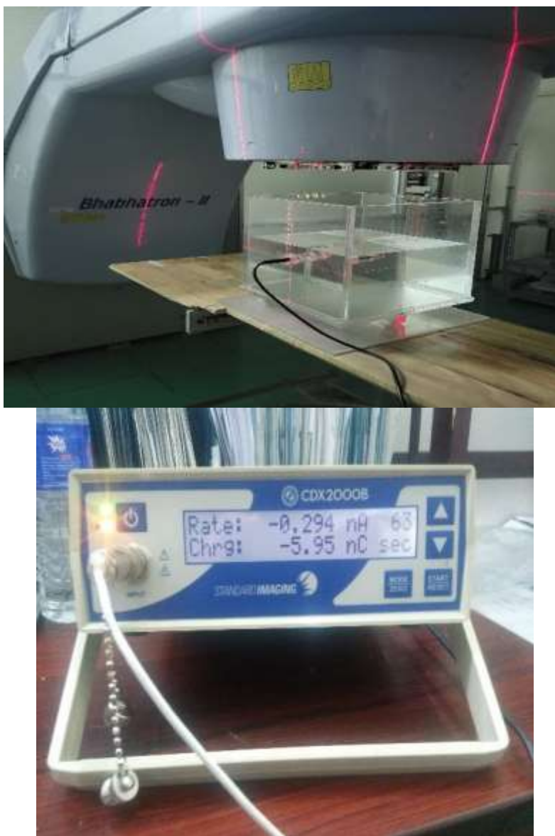
Hình 2. Bố trí thí nghiệm đo sử dụng phantom nước, buồng ion hóa và máy ghi đo nC
