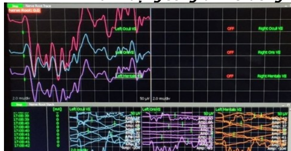
Hình 2. Hình ảnh dạng sóng bất thường khi cảnh báo liên quan dây VII
