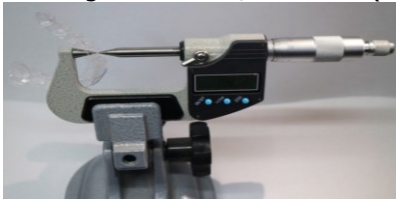
Hình 1: Thước đo điện tử panme Syntek dùng để đo độ dày các điểm của khay chỉnh nha
