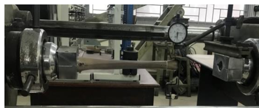
Hình 4. Thí nghiệm khảo sát khả năng chịu lực uốn.
