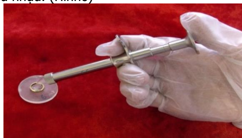
Hình 6: Silicone được bơm vào vòng khuôn kim loại
