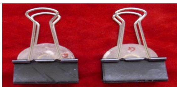
Hình 7: Các mẫu thử được kẹp lại cố định và giữ ở nhiệt độ phòng 3 ngày.
