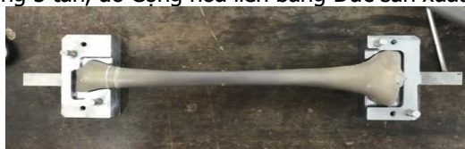
Hình 2.3. Dụng cụ ngoàm bằng kim loại cố định chắc hai đầu xương trước khi đưa vào máy đo.
