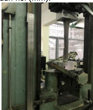
Hình 2.4. Thử nghiệm khảo sát khả năng chịu lực nén
