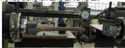
Hình 2.6. Thí nghiệm khảo sát khả năng chịu lực uốn.
