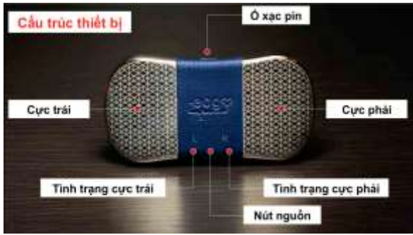
Hình 1: Cấu trúc của thiết bị ECGo
