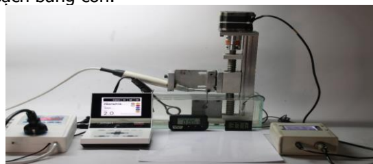
Hình 2: Hệ thống thử nghiệm tính kháng mỏi chu kỳ tĩnh và động
