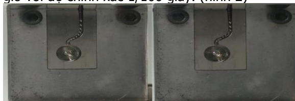
Hình 3: Trâm PTU F2 trước (hình A) và sau (hình B) khi thực hiện thử nghiệm
