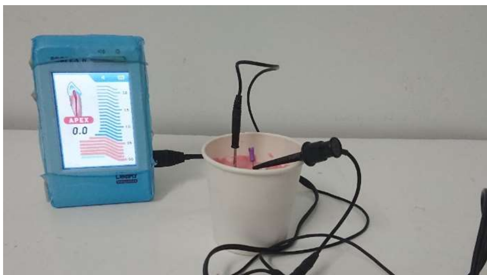
Hình 1. Mô hình thử nghiệm đo chiều dài làm việc bằng máy định vị chóp
