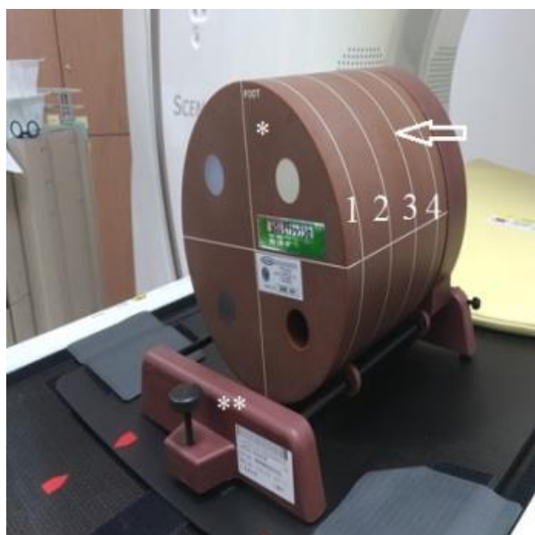
Hình 1. Mô hình ACR CT với 4 mô đun và mô đun 2 để đánh giá độ phân giải tương phản thấp
